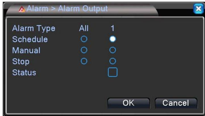
Control alarm output status, display “●” for 「All」 「1」 stand for current DVR supported alarm output number.
